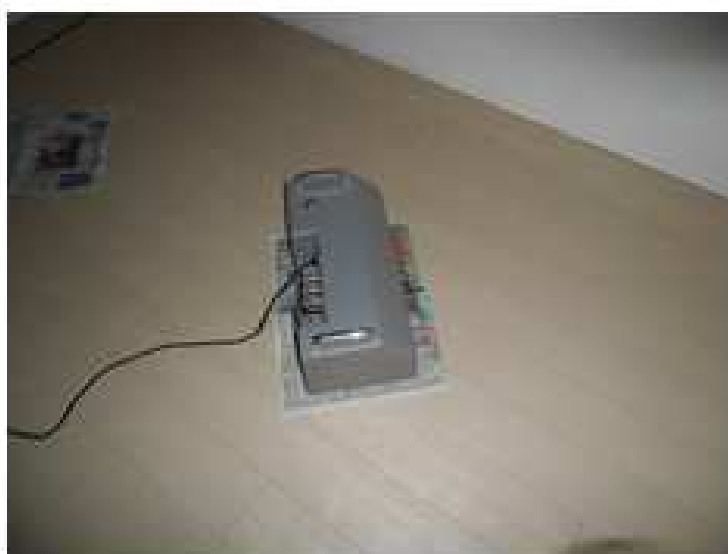
軽量床衝撃音騒音レベル測定(タッピングマシン)
